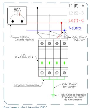
Esquema de Ligação DPS Sem Escala
