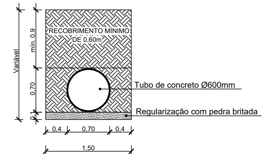
DETALHE 06 SEÇÕES DE ESCAVAÇÃO E REATERRO P/TUBULAÇÃO SEM ESCALA
